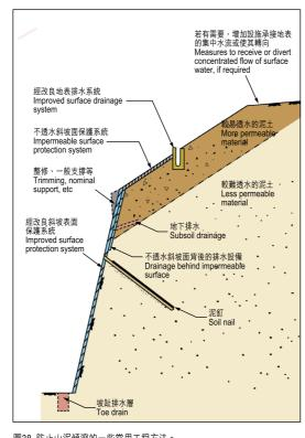
圖38. 防止山泥傾瀉的一些常用工程方法。 Figure 38. Common engineering works to prevent landslides.
