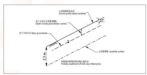
圖B-7. 用作斜坡穩定性分析的事發地點代表剖面圖 - 下部平面滑動。
