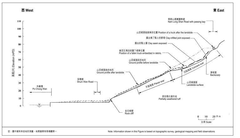
圖B-2. 崩塌地點剖面A-A。 Figure B-2. Section A-A through the landslide
