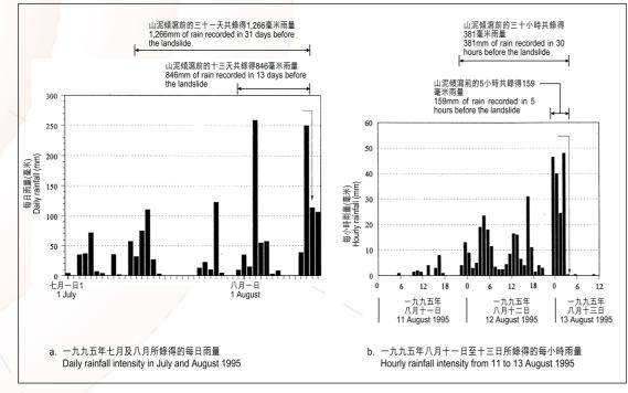
圖B-9. 土力工程處編號H05雨量計的雨量記錄。 Figure B-9. Rainfall record of GEO raingauge No.H05.
