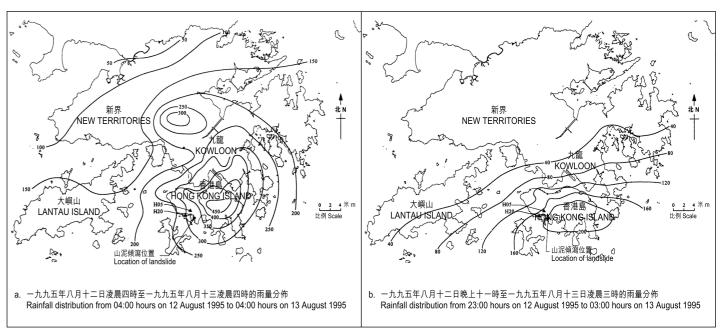
圖B-8. 山泥傾瀉前的雨量分佈。 Figure B-8. Rainfall distribution prior to the landslide 圖例 Legend: 等雨量線(毫米計) ▲ 土力工程處雨量計 Isohyet of rainfall in millimetres
