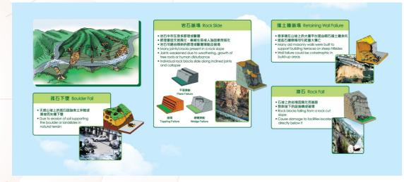
圖31. 常見的山泥傾瀉模式(非土坡)。 Figure 31. Common failure mechanism of landslides (non-soil slopes).
