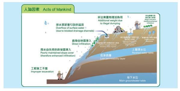
圖35. 導致山泥傾瀉的一些常見人為因素。 Figure 35. Some common human causes of landslides.
