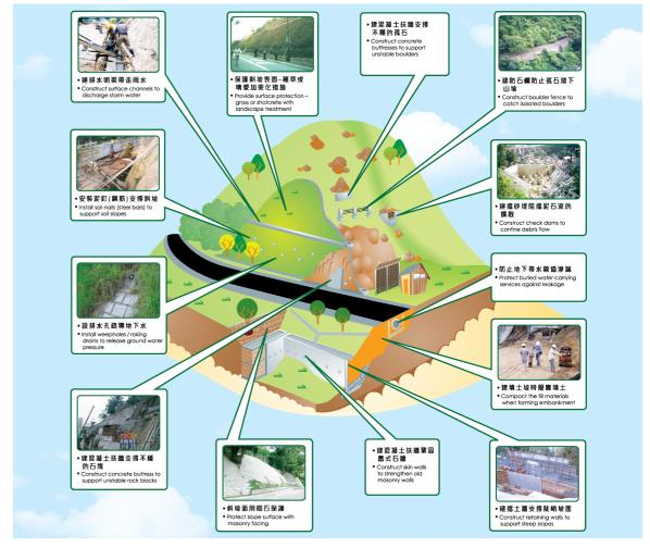
圖37. 防止及防治山泥傾瀉的一些常用工程方法。 Figure 37. Common engineering works to prevent or mitigate landslides.
