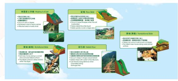
圖32. 常見的山泥傾瀉模式(土坡)。 Figure 32. Common failure mechanism of landslides (soil slopes).
